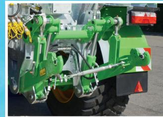
**Встроенный подъёмник и гидравлическое оборудование „AUTOMATE 2+4”**
