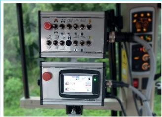
**Терминал в кабине трактора + Экран Touch-Control**
